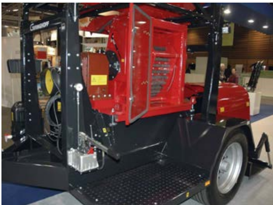
Le Silo Force Mill de Geringhoff. La machine requiert une puissance d'environ 75 kW.
