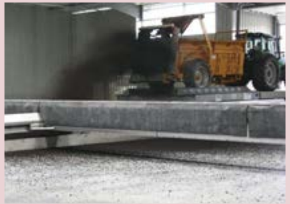
Mis en service en 2007, le banc d'essai Cemob décrypte la répartition longitudinale et transversale d'un appareil, tout au long du cycle de vidange.
