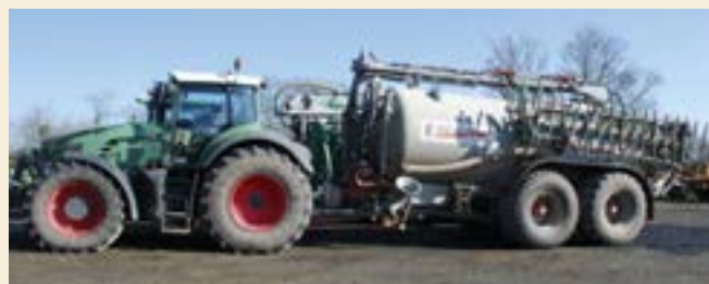
L'entreprise possède 3 épandeurs à fumier et 2 tonnes à lisier dont cette Samson de 18 m 2 observée par des visiteurs. Elle est dotée d'un pendillard pouvant atteindre 21 m.
