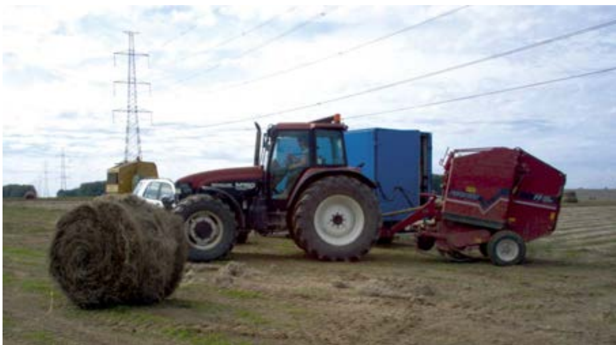
Pour faciliter le déroulage de certains produits comme le lin, il peut être indispensable de placer des liens tout au long de la formation de botte.
