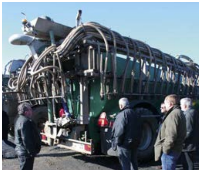
L'entreprise possède 3 épandeurs à fumier et 2 tonnes à lisier dont cette Samson de 18 m 2 observée par des visiteurs. Elle est dotée d'un pendillard pouvant atteindre 21 m.
