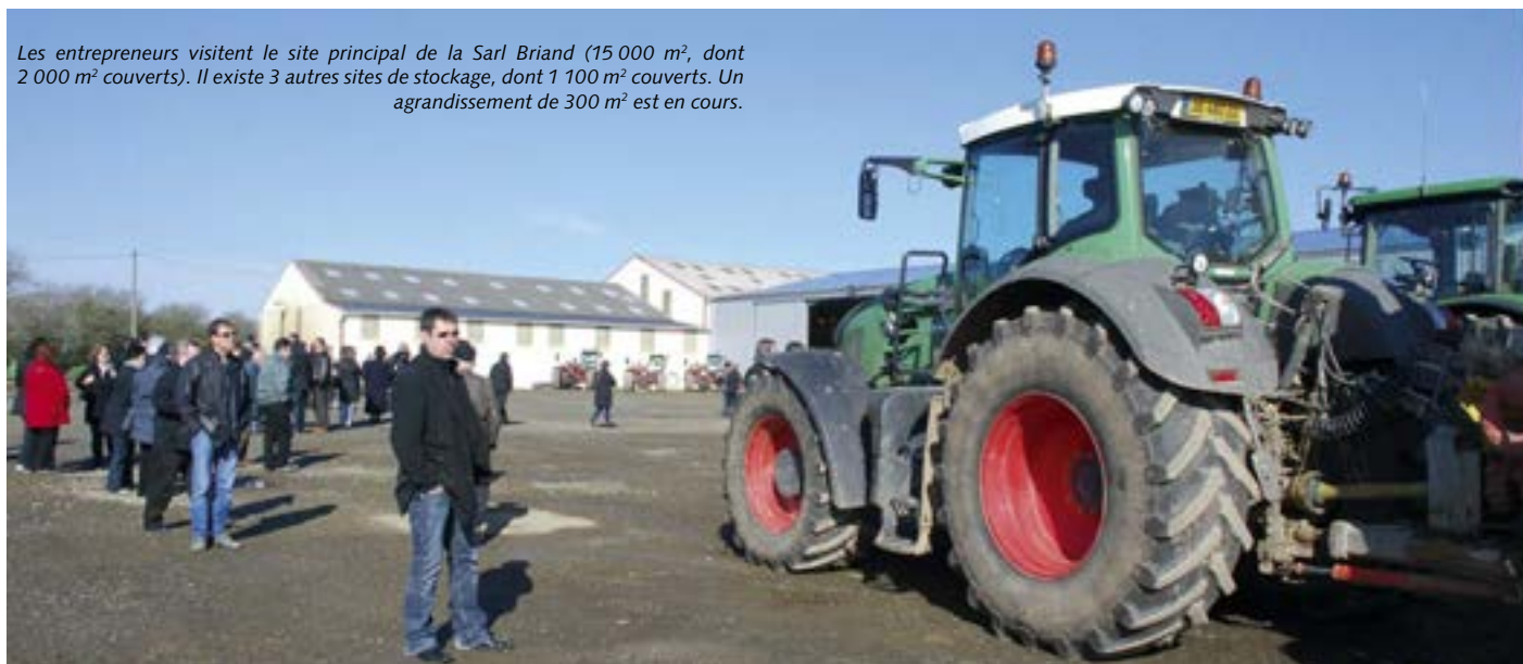
L'entreprise possède 3 épandeurs à fumier et 2 tonnes à lisier dont cette Samson de 18 m 2 observée par des visiteurs. Elle est dotée d'un pendillard pouvant atteindre 21 m.
