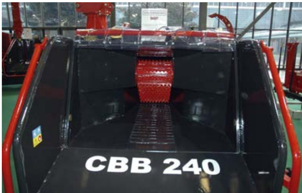
Le broyeur de branches CBB 240 de Bugnot avec ses deux tapis d'amenage.
