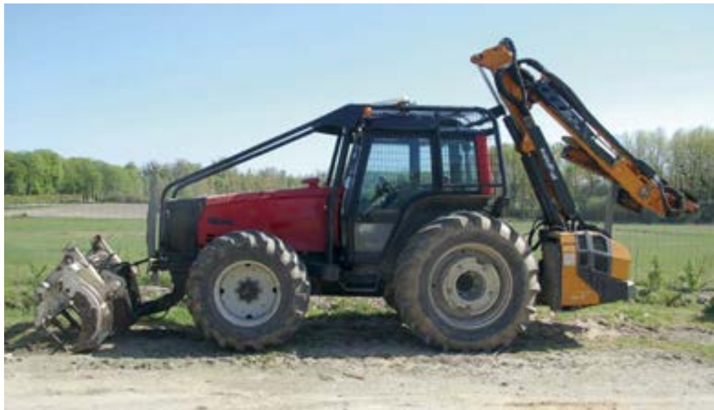
Les lamiers interviennent pour l'élagage des branches sous les lignes moyenne et basse tension.
