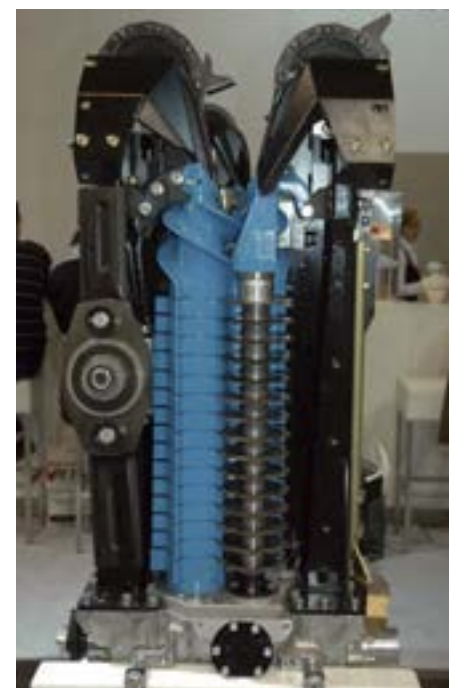
Le broyeur du nouveau cueilleur à maïs Horizon Star II de Geringhoff.
