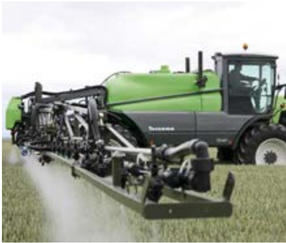
Maintenir la rampe à hauteur constante est un des objectifs prioritaires.
