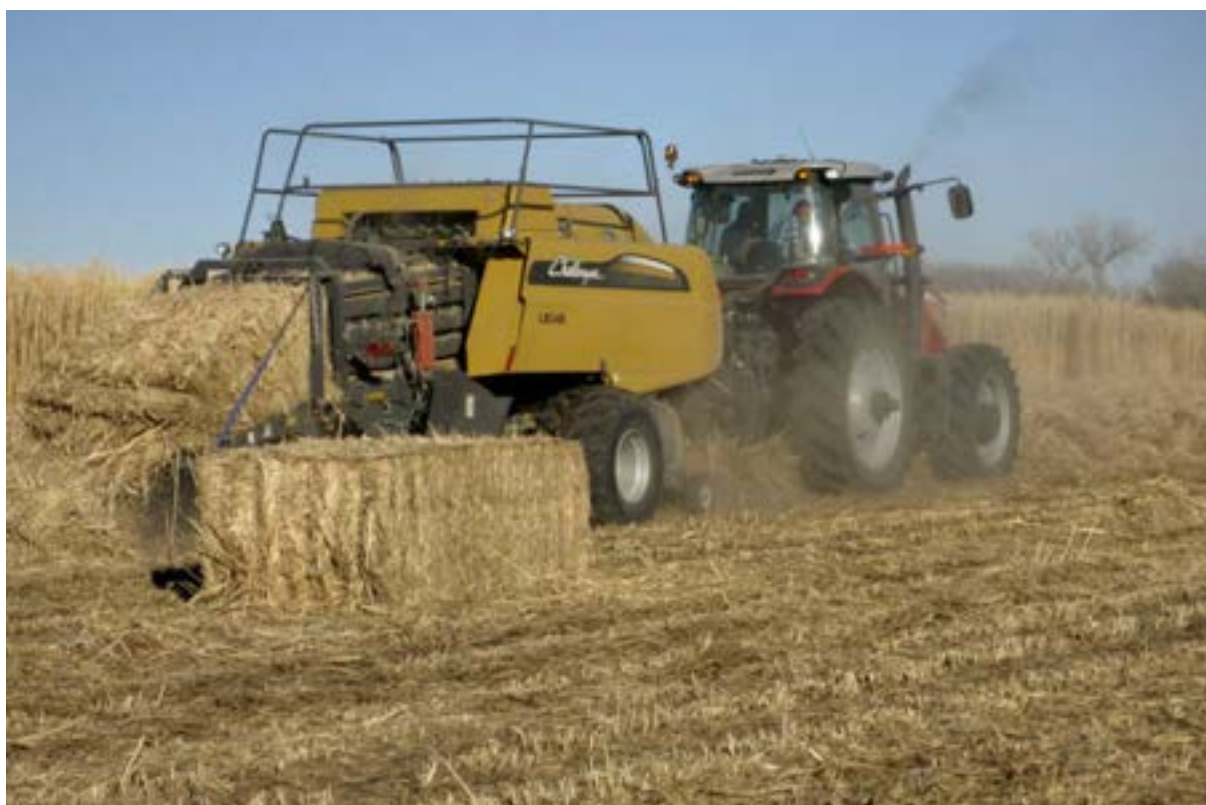
Conçus pour le foin ou la paille, les systèmes d'alimentation des presses ont parfois du mal à accepter des produits plus ligneux fortement enchevêtrés.
