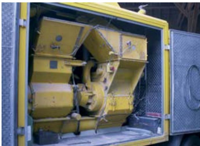
Le côté droit du camion ouvert, avec à droite le broyeur et l'aplatisseur à gauche
