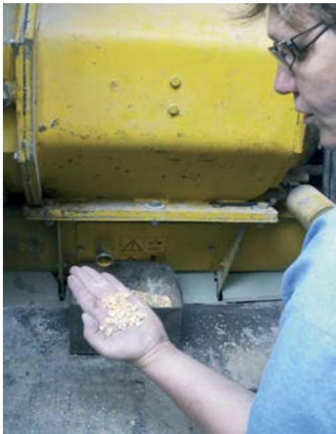
Vérification de la finesse du produit aplati à la sortie de l'aplatisseur
