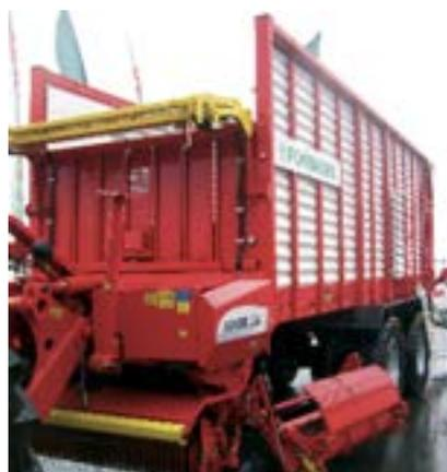
Pöttinger propose désormais sur sa gamme d'autochargeuses Jumbo un système de pesée précis à 2,5 %. Il permet, associé au boîtier Isobus, d'enregistrer les données telles que poids de fourrage récolté, durées de chargement, de transport, temps d'attente, de circulation à vide et en charge.
