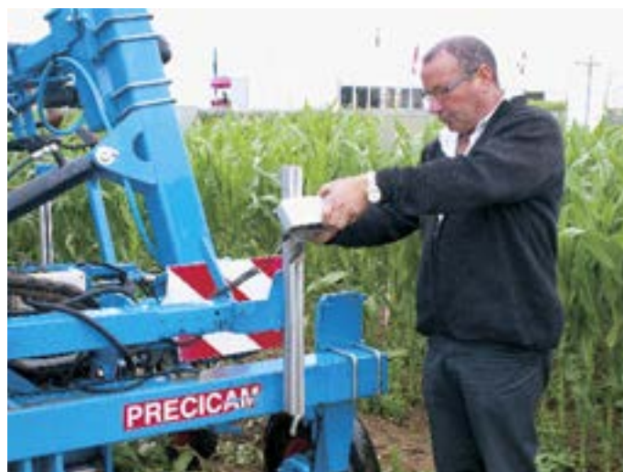
Jacques Enfrin (responsable régional Carré) présentant la caméra du système de guidage Précicam permettant une précision du binage jusqu'à 3 cm de chaque côté du rang.
