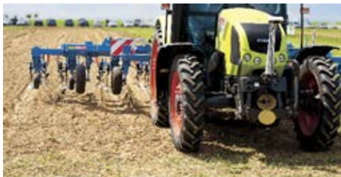
Claas Cam Pilot, alternative aux signaux GPS dans les zones vallonnées et petites parcelles.
