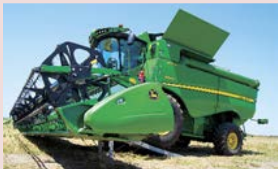
Coupe de 10,70 m et trémie de 14 100 l pour la série S.
