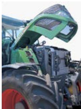
L'accès au filtre d'admission situé au-dessus du bloc nécessite d'enlever le panneau latéral.
