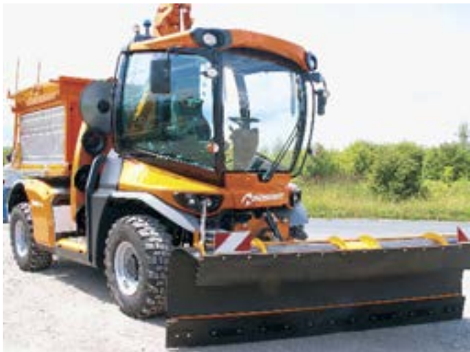
Vialys est le premier véhicule qui peut être équipé simultanément d'accessoires de déneigement et d'un bras de fauchage/débroussaillage/élagage.
