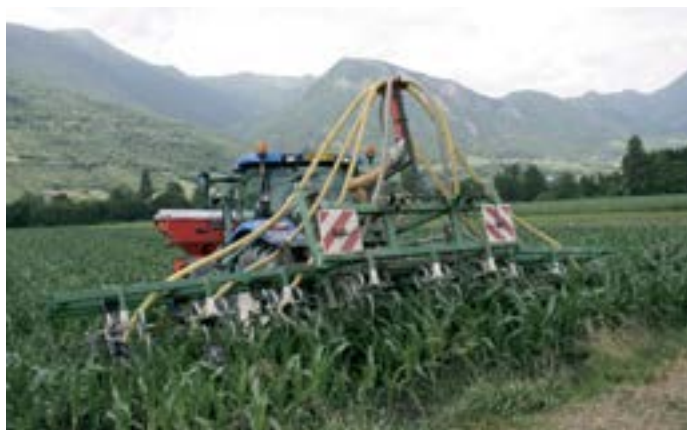
Laurent Perrier a modifié la bineuse qui servait à enfouir l'ammoniac, afin de pouvoir épandre de l'urée.
