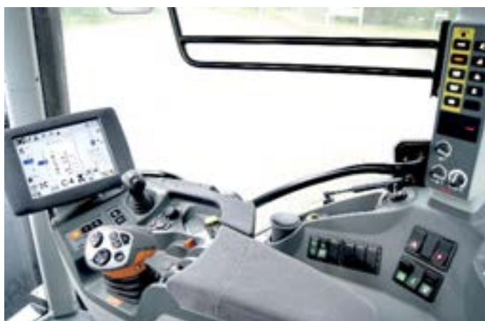
La version Cebis intègre un écran de 8,3" et une majorité de commandes sur l'accoudoir grâce au levier CMotion.
