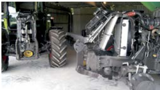
Le filtre à particules a été intégré sous le capot moteur. Notons également une nouvelle disposition du système de refroidissement qui simplifie l'entretien courant.
