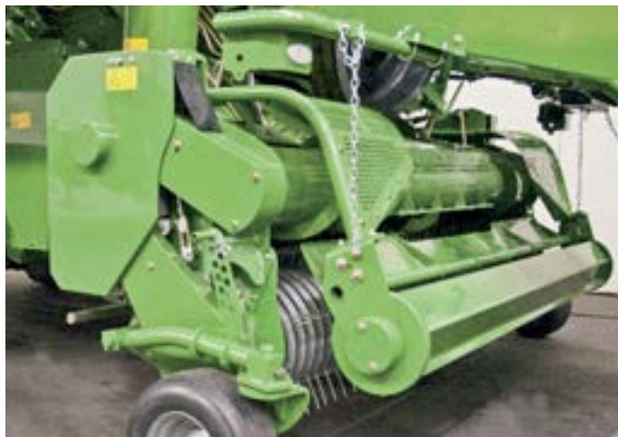
La Big Pack High Speed pourra recevoir un pick-up dont le rouleau est entraîné.
