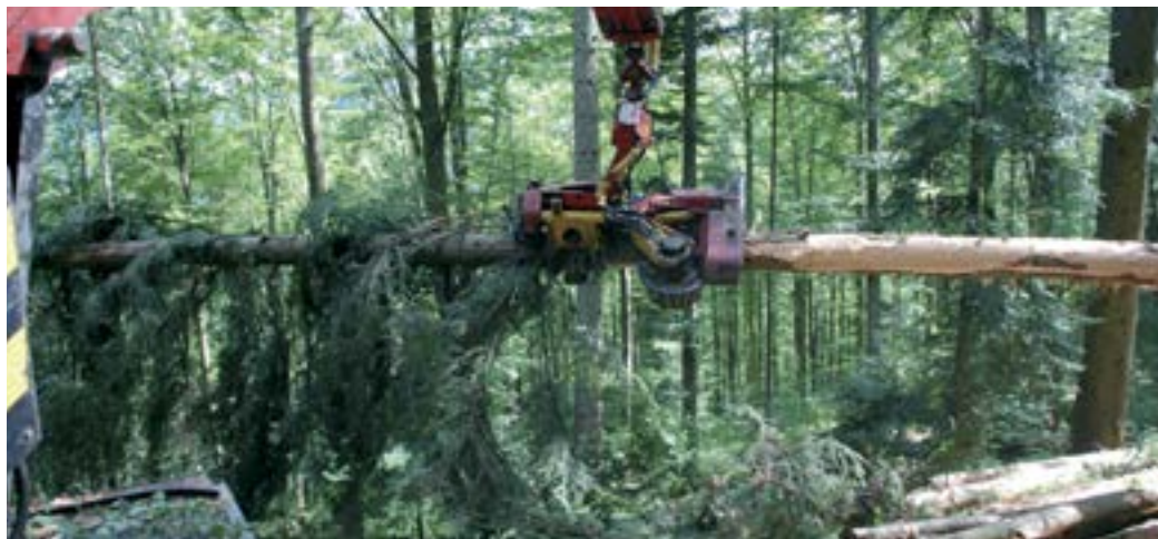
Chaque tronc est ébranché, écorcé et coupé en quelques secondes.
