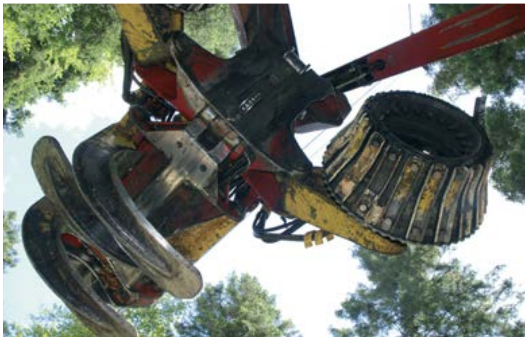
La tête peut tirer une charge de 4 t maximum.
