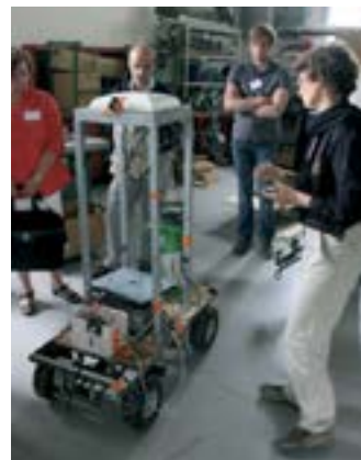
Christelle Gée présente le prototype du robot de pulvérisation localisée « I-Weed » équipé d'une caméra et guidé par RTK.
