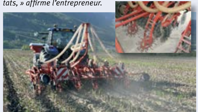
Le strip-till permet de retravailler directement après une culture, ici maïs sur maïs, en se décalant d'un demi-rang. La trémie frontale permet un apport localisé d'engrais.
