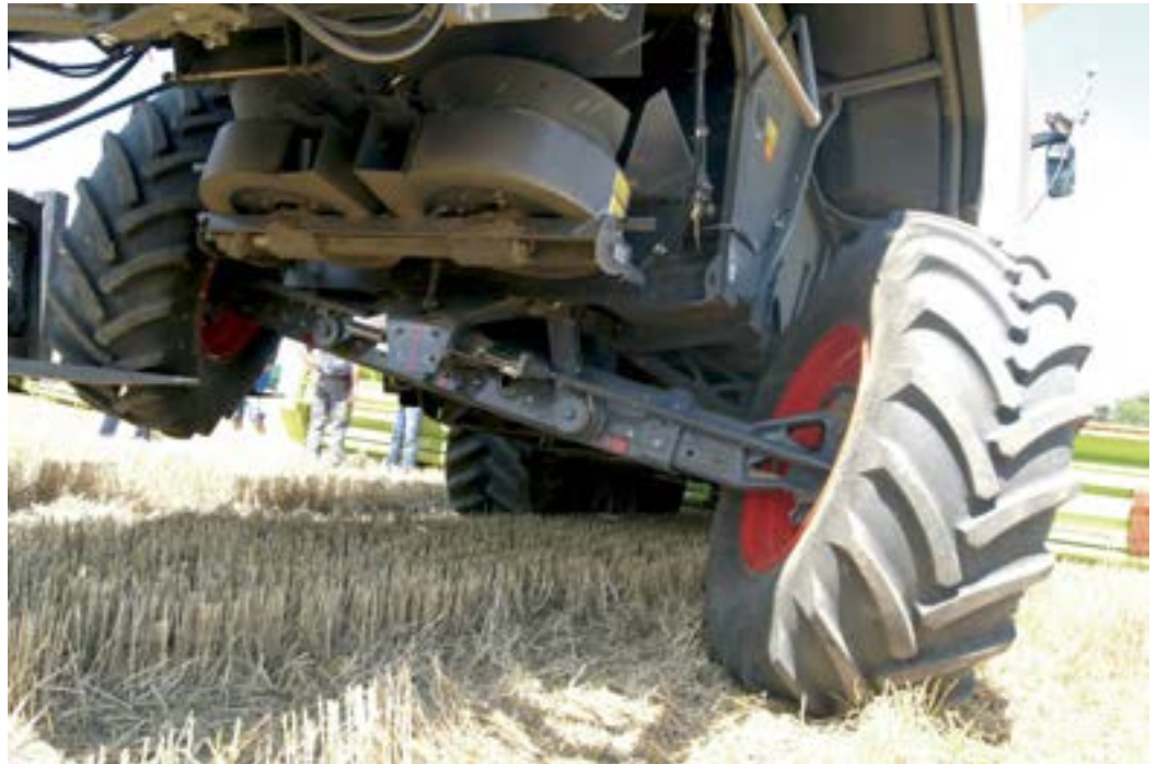
Pour monter des pneumatiques de grand diamètre, le constructeur a conçu un pont arrière pendulaire.
