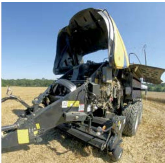
Le capot frontal s'ouvrant grâce à des vérins à gaz offre deux positions et libère l'accès aux principaux organes.
