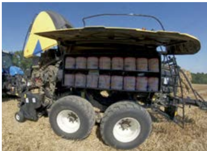
Les capots latéraux rendent totalement hermétique les réserves de ficelle.
