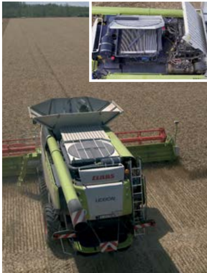
Un nouveau système de refroidissement équipe les modèles 770 et 780.
