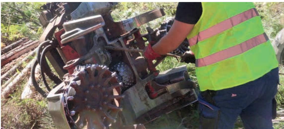
Ci-dessus sur un chantier de printemps en période de montée de sève : l'opérateur retire de l'écorce accumulée dans la loge de la roulette.
