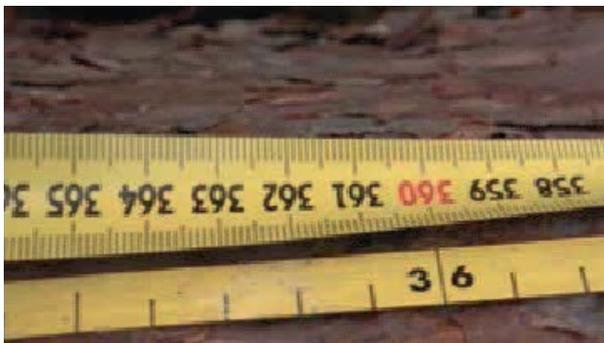
**Ruban de mesure** : à contrôler par rapport à un ruban en acier de référence placé parallèlement au premier. Il doit être remplacé si des écarts sont observés. Bien vérifier la correspondance du point 0.
