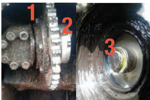
*«J'ai vécu plusieurs semaines d'hésitation face à des longueurs qui faisaient le yoyo. A l'occasion de l'ouverture du capot (le graissage quotidien de la tête ne nécessite pas d'ouvrir le capot sur ce modèle) j'ai pu constater un écartement anormal de la roulette sur son support (1).*
