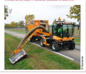
un boîtier avec roue libre incorporée. Les rotors de diamètre 168 sont équipés de marteaux lourds B2. Le suivi du terrain est assuré par un attelage flottant et une position flottante du vérin d'inclinaison.
