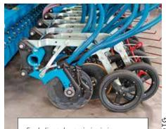
Sur la ligne de semis équipée du Double Shot, la deuxième descente s'ajuste pour écarter plus ou moins les deux produits, semences et/ou engrais.
