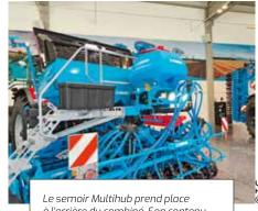
à l'arrière du combiné. Son contenu peut, au choix, être épandu sur le sol grâce à des éclateurs ou incorporé avec la semence.
