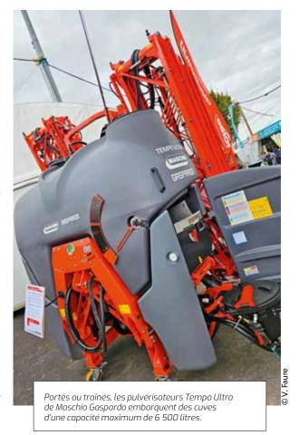
l'acier, mentionne Brice Bidart. Et on a désormais un éventail complet de rampes Pommier sur ces pulvérisateurs-là, avec des cadres reconfigurés spécialement pour les recevoir. » Autre alternative d'équipement du côté des panneaux de commande, soit tout manuel, soit tout électrique.
