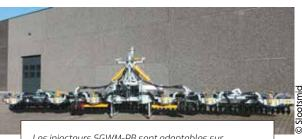
Les injecteurs SGWM-PB sont adaptables sur la plupart des automoteurs d'épandage du marché, mais aussi sur les tonnes à lisier tractées, sous réserve que celles-ci soient équipées de coupures de tronçons et connectées Isobus.
