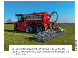
la ligne. L'équipe R&D de Slootsmid va relever le défi avec le SGWM-PB, en modifiant quelques-uns des éléments standards de ses injecteurs à disques. « Nous avons introduit l'Isobus pour faciliter la communication avec la console du tracteur ou de l'automoteur, et surtout nous avons installé sur cette machine six broyeurs – répartiteurs interconnectés, correspondant à une largeur de travail de 12 mètres avec 33 buses d'injection montées en duo », décrit Mark Ros.
