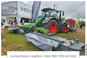
de travail: 9,60 et 10,10 m. Les modèles portant la mention KC sont équipés d'un conditionneur à dents (ou « doigts »), tandis que la mention RC fait référence au conditionneur à rouleaux.
