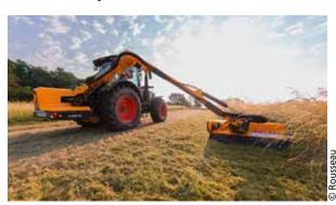
Le constructeur de matériel d'entretien des accotements enrichit sa gamme d'épareuse avec la Kondor. Cet outil peut être équipé sur un bras avancé ou un bras déporté avec une longueur de 5,6 à 6,1 m. Rousseau propose également l'équivalent électrique avec la E-Kondor. Cette épareuse est annoncée avec un fonctionnement plus silencieux, une économie de carburant et 80 kg de moins que son équivalent hydraulique pour des performances identiques.
