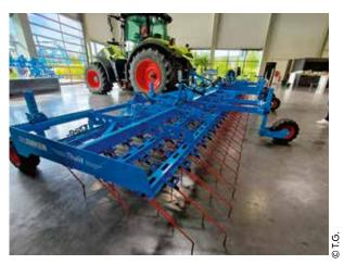
constante sur toute sa course. Pour les demi-tours la Thulit se relève en V afin d'éviter d'endommager les cultures fragiles. Le repliage unilatéral est possible pour limiter les recroisements. Au transport, les dents s'escamotent automatiquement pour réduire la largeur. La trémie Multihub en 200 ou 500 l peut prendre place sur la herse.
